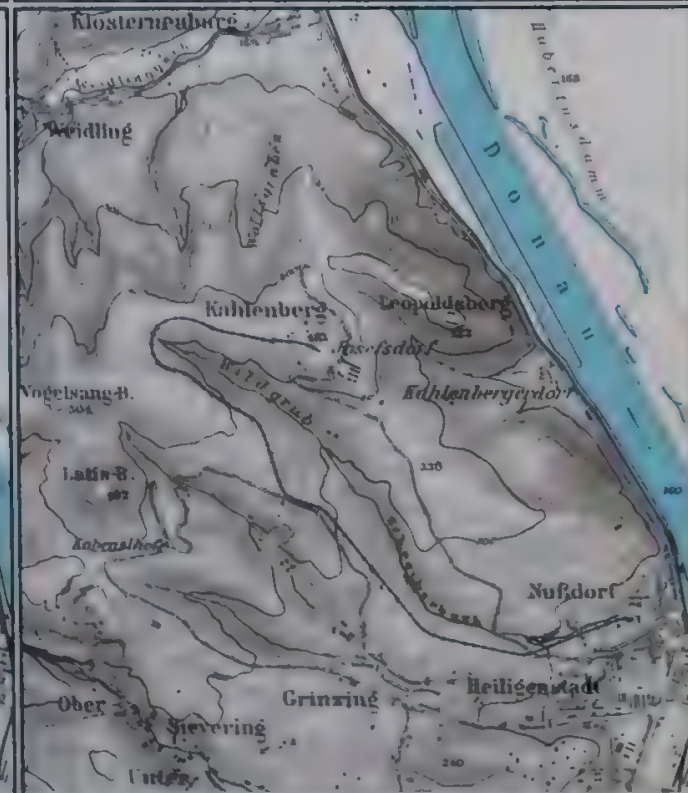
4. Höhenlinien mit Böschungsschraffen Die Striche laufen i.d. Richtung des Wasserabflusses ihre Stärke wächst im Verhältnis zur Steilheit der Böschung
